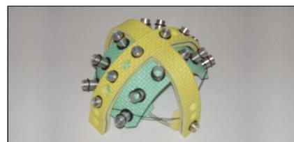
**Figura 3.** Dispositivo per il posizionamento degli optodi sul capo del bambino con copertura di un'ampia superficie.
