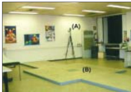
Figura 3. Il laboratorio della gait analysis: (A) videocamera del sistema optoelettronico; (B) piattaforma di forza.
